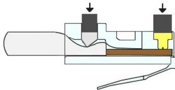
8. Testear si engancho... Si el cable esta bien hecho, una persona normal no debería poder sacar el cable con la mano. Pero no no tiren demasiado. Puede estirar el cable y cambiar sus características. mirar la ficha y compararla con el diagrama y darle un tironcito para ver que no se salga.
