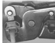
La herramienta empuja dos partes claves de la ficha, una se encarga de mantener el cable y la otra perfora los alambres individualmente para hacer contacto.
